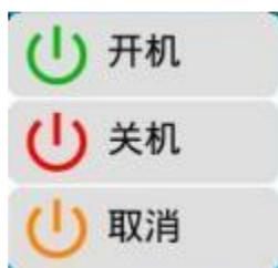
若确认要开机，单击弹出窗口的“开机”键，系统进入运行状态，主页面上机组状态显示由“停机”变成“运行”，若确认要关机，单击“关机”键，可对系统执行停机操作，系统根据逻辑关闭系统；点“取消”键可直接关闭窗口不执行相关操作。
