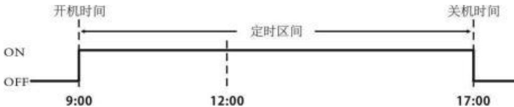
若机组上电时，时间在定时区间外，系统保持当前状态，当时间到开机时间(9:00)，系统执行开机命令，机组正常开机；在定时区间内可按“关机”键执行手动关机或到“关机时间”后系统自动关机；
